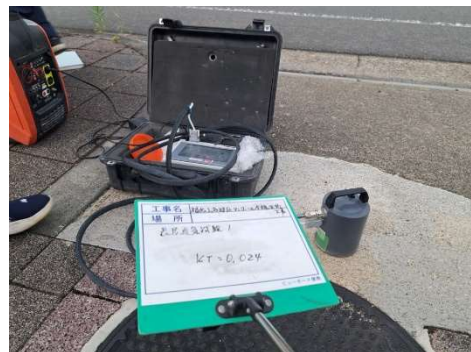
現地における表層透気試験の測定状況
