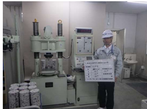
公的試験機関でのコアの圧縮強度試験
