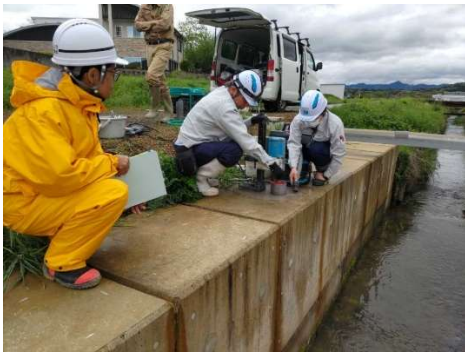
強度試験用のコアの現地採取
