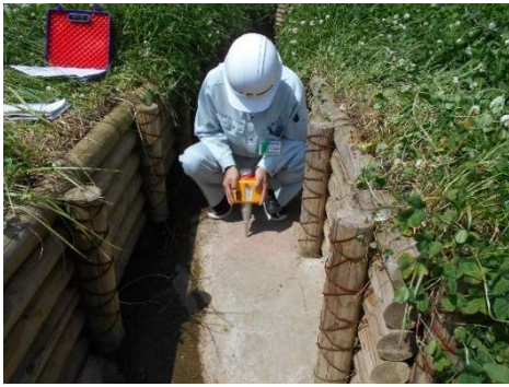
テストハンマーによる強度測定
