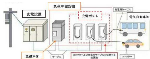
図 分離型の急速充電設備のイメージ
