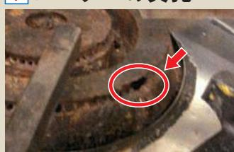
ガスバーナーの炎孔が腐食して、穴がつながっています。
