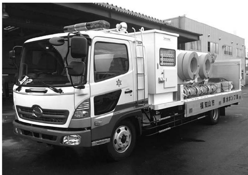
排水ポンプ車は全長約8.5mで、ポンプ6基、排水ホース、発動発電機ほか、夜間にも稼働できるようバルーン式投光器を備えています。
