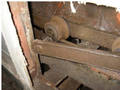
不燃物供給コンベヤローラーチェーン損傷箇所
