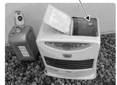
上からのぞくと、内蔵タンクのフィルターが見えます。
