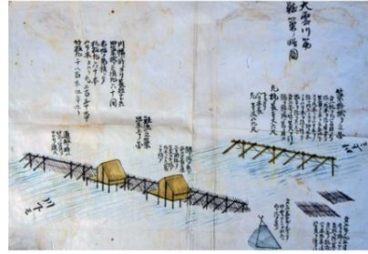
写真1 大雲川筋鮭築ノ略図
