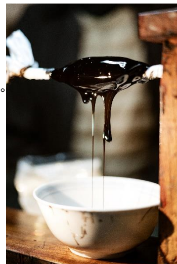
漆を濾紙で包み、不純物を取り除く工程。漆は自重で垂れ落ちます
