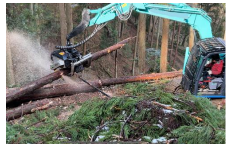
高性能林業機械 （プロセッサ）による造材
