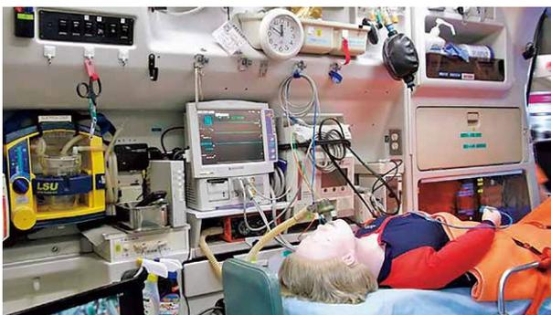
救急車内部。酸素呼吸器、AED、人工呼吸器、自動心マッサージシステム、オゾンガス発生装置など、高度な技術を備えた医療機器を搭載しました。
