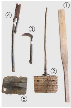
写真1 屋根葺き道具 (①)ハゴイタ ②コテ ③カマ (④)ハサミ ⑤テゴテ)
