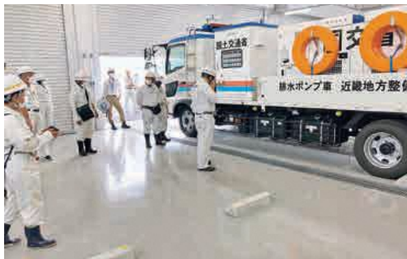
由良川防災ステーションに配備された排水ポンプ車
