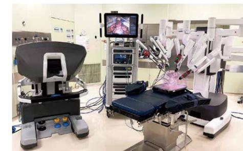
写真左) サージョンコンソール：ロボットアームの操作台です。医師が3D映像を見ながら、アームを遠隔操作します。
