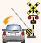
例えば故障や停電などで踏切が作動しなくなると、遮断棒が重力によって下り、車や人の侵入を防ぐシステムと同じ
