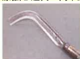
皮むきカマ ウルシの木の荒皮をはいで幹の表面をきれいにする。次のカンナが使いやすいように準備する。
