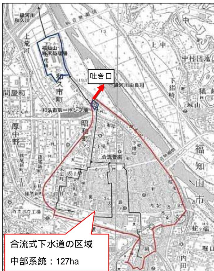
策を平成 25 年度末までに完了することが義務づけられていますが、本市では、緊急改善対策として、『汚濁負荷量の削減』と『公衆衛生上の安全確保』を目標に、平成 22 年度完了に向けて工事を進めています。具体的には、分水施設と貯留施設(6,000m<sup>3</sup>)を設けることで、汚濁負荷の高い降雨時初期の合流下水を本管から越流させて貯留します。貯留した下水は、本管が平常水位に戻った後に本管へ戻し、通常の処理を行います。
