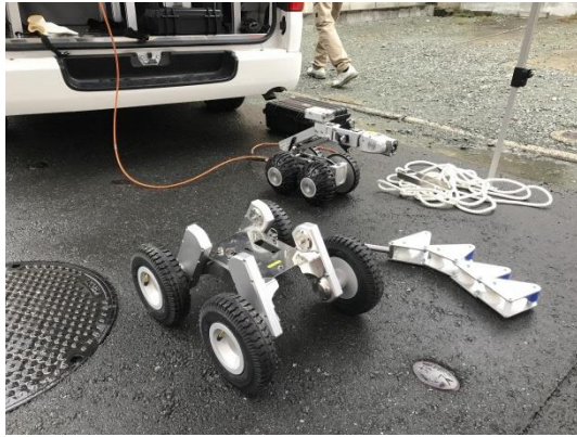
写真2-1-7 管きょ調査作業の状況
