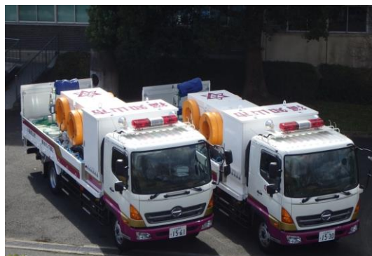
写真 2-1-2 排水ポンプ車
