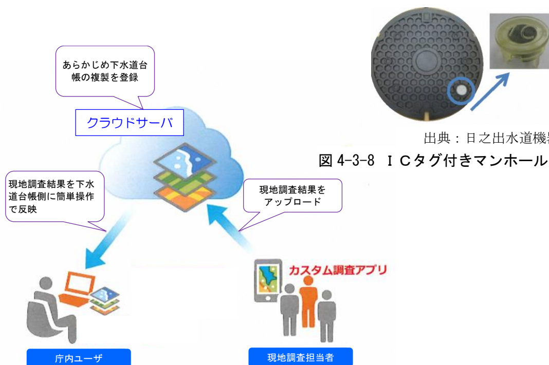
図4-3-7 GPS機能を搭載したタブレット端末による現地調査イメージ
